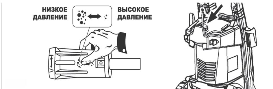
В зависимости от применяемого вами моющего средства, можно отрегулировать количество подаваемой моющей жидкости, при переводе регулятора в положение «MIN» количество моющей жидкости уменьшается, при переводе в положение «MAX» увеличивается.
