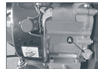
Заправка маслом нового двигателя
