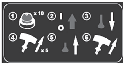
Рис. 11 Алгоритм запуска двигателя
