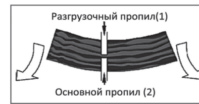
Рис. 17 Распиливание дерева, когда его нижняя часть находится под напряжением
