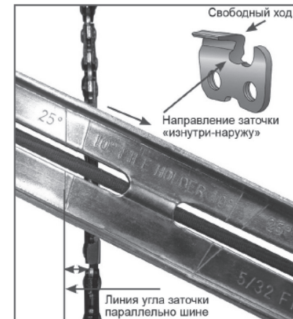
Рис. 26 Определение угла заточки
