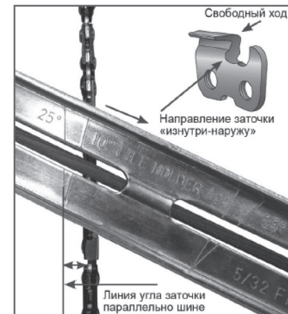
Рис. 26 Определение угла заточки
