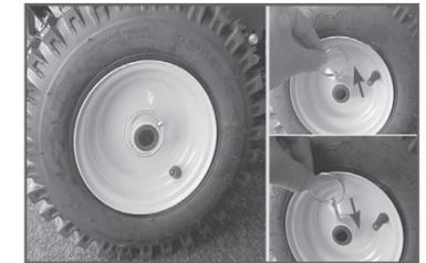
Установка шплинта на левом колесе шнека
