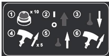
Рис. 11 Алгоритм запуска двигателя
